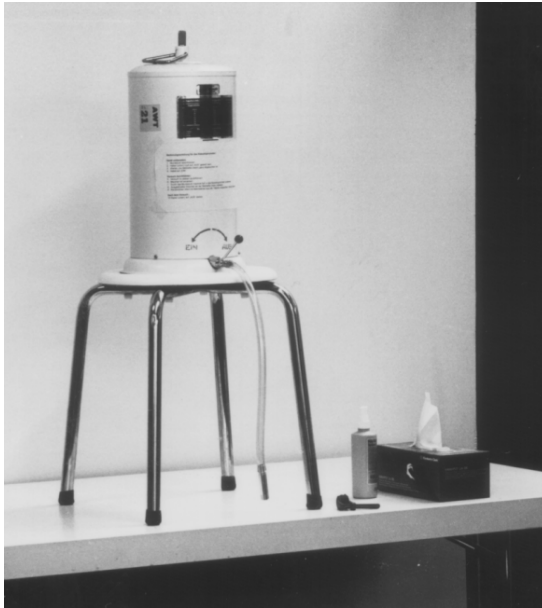
Abb. 4 Links: Kesselspirometer zur Bestimmung der Vitalkapazität im Stehen. Rechts: Spirometer zur Bestimmung der Atemvolumina und der relativen Sekundenkapazität.
